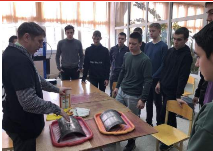
Евгений Александрович СОБОЛЕВ, инженер лаборатории контроля сварных конструкций «БЭК-ремонт», провел мастер-класс для сварщиков второго курса группы 12 по неразрушающему контролю капиллярным способом. Показал процесс обезжиривания поверхности, нанесения пенетранта и проявителя для обнаружения дефектов изделия.
