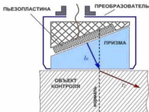
В зависимости от угла падения в объект контроля проникают только продольные волны, продольные и поперечные, только поперечные или поверхностные волны.
