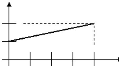
A8. Определите работу силы при перемещении тела из точки с координатой  $X_0=0$  в точку с координатой  $X=4$  м (см. рис.)
