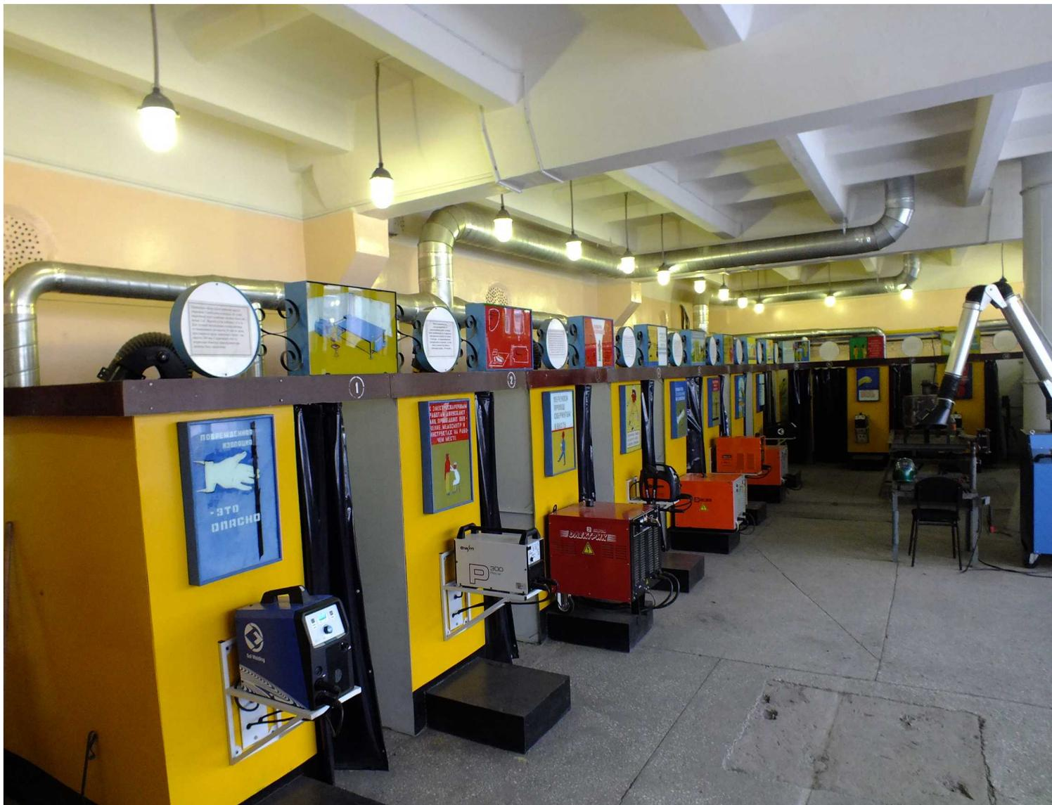
Для удобства проведения сварочных работ, оборудовано 18 изолированных рабочих мест. Каждое рабочее место оснащено светозащитной пластиковой шторой. Сварочное оборудование установлено на специальных кронштейнах и подставках, что удобно для проведения инструктажей по заданию параметров сварочных работ, не перегружает рабочие кабинки и позволяет мастеру производственного обучения следить за сохранностью оборудования.
